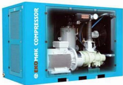
Мощный промышленный винтовой компрессор ЕКО 200 D VST имеет прямой привод между трехфазным электродвигателем мощностью 200 кВт и винтовой парой. Компрессор имеет функцию плавного регулирования объема подаваемого сжатого воздуха в интервале от 7,8 до 35,4 м³/мин с давлением от 8 до 13 Бар в зависимости от объема потребления, что позволяет снизить расход электроэнергии на величину от 15 до 30%. Компрессор оборудован звукозащитным кожухом, снижающим уровень шума до 78 дБ.
